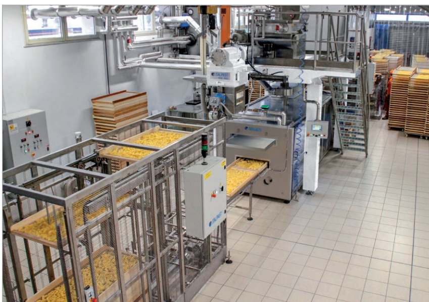
Produktionslinie zur Produktion von Nudeln, ausgestattet mit SOGEVAC FP Pumpen. Mit freundlicher Genehmigung ITALPAST S.r.l., Parma, Italien
