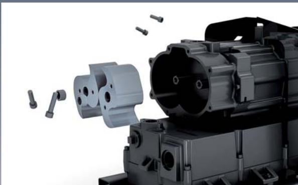
Der integrierte Schalldämpfer ist mit einer Ablassöffnung für eventuell anfallendes Kondensat ausgestattet und kann zu Reinigungszwecken ausgebaut und geöffnet werden.
